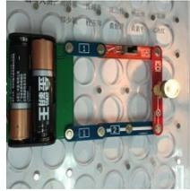
在好好搭搭的电子积木套件中，由开关、灯泡、电池盒、导线和电池组成电灯的电路，这个是控制灯泡明亮的最基本的电路图。
