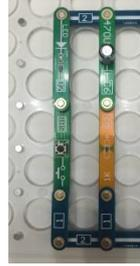
当开关断开，并按下电键不放，发光二极管被\_\_\_\_\_，开始时发光二极管 \_\_\_\_\_（较亮或较暗），几秒后，发光二极管逐渐\_\_\_\_\_（变亮或变暗），此时电路中的放电电流减小，直到为零，那么电容器放电结束。
