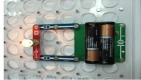
在好好搭搭的电子积木套件中，由灯泡、电池盒、导线和电池组成电灯的电路，这个是让灯泡亮起来的最基本的电路图。
